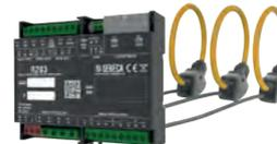
**Kit analizzatore di rete trifase, Ethernet, ingresso universale e terna di sensori rogowski L40 Ø12, 100mV/1KA-50Hz**
